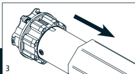
1. Introducir el adaptador en la abrazadera haciendo coincidir la estría con la muesca de referencia y empujar hasta el tope.
