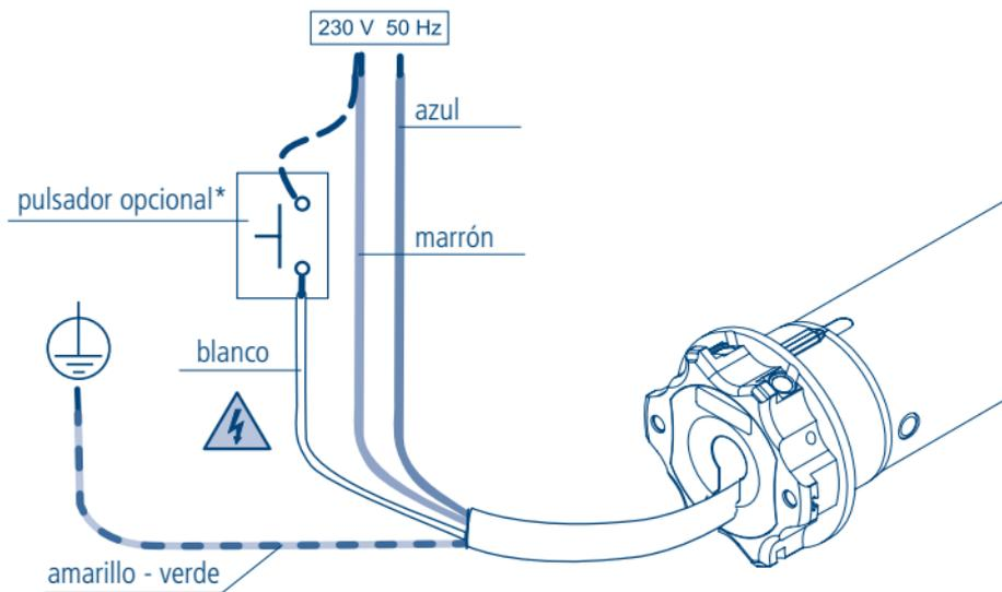
\* La instalación del pulsador es opcional, conectándose a Fase (cable marrón) o a Neutro (cable azul) indistintamente. Con el pulsador el motor funcionará en modalidad paso a paso (subida, stop, bajada, stop,...).
