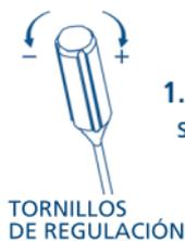
1. Para descubrir cual de los dos tornillos hay que utilizar basta observar el sentido de rotación de la abrazadera fin de carrera: si la abrazadera fin de carrera arrastrada por el rodillo gira en la dirección A, utilizar el tornillo de regulación A para ajustar el fin de carrera en ese sentido. Si la dirección es opuesta (B) utilizar el tornillo de regulación B.
