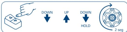
apretar los pulsadores indicados en secuencia rápida y, en el paso señalado con "HOLD", mantener apretado el pulsador para comprobar que se produce el movimiento de confirmación del motor
