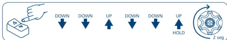
La cancelación de uno o ambos fines de carrera quedará constatada por el hecho de que el motor se moverá brevemente realizando una pausa antes de reanudar el movimiento hasta que ambas posiciones no se memoricen de nuevo en modalidad automática o manual.
