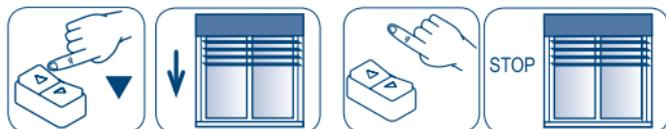
Pulsando uno de los dos botones el motor se mueve en la dirección deseada. El motor se para al soltar el botón o al alcanzarse el time-out.
