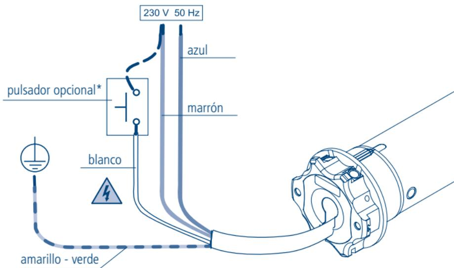
\* La instalación del pulsador es opcional, conectándose a Fase (cable marrón) o a Neutro (cable azul) indistintamente. Con el pulsador el motor funcionará en modalidad paso a paso (subida, stop, bajada, stop,...).
