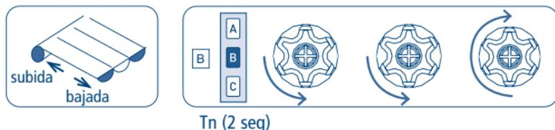
A partir de este momento, cuando el WindTec Lux accione la apertura del toldo con el automatismo luz (si habilitado), el toldo se colocará en la posición intermedia adicional.
