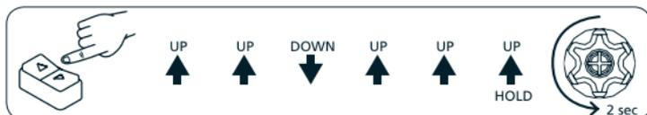
**Attention! Si la séquence prévoit une répétition de commandes identiques (Up+Up/ Down+Down), il est nécessaire d'interposer la position Stop si le type de bouton le prévoit.**
