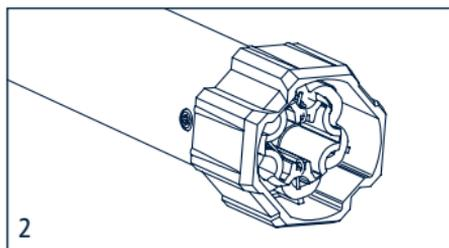
2. Montar la polea de arrastre en el perno del motor hasta el clic del resorte de bloqueo.
