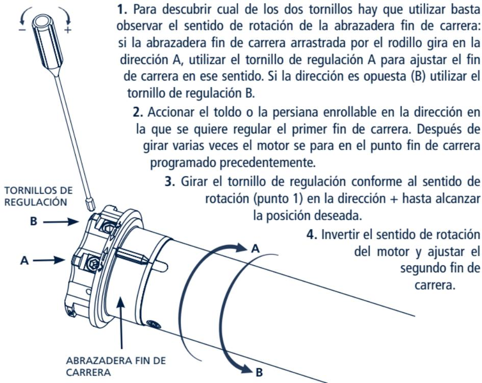
1. Para descubrir cual de los dos tornillos hay que utilizar basta observar el sentido de rotación de la abrazadera fin de carrera: si la abrazadera fin de carrera arrastrada por el rodillo gira en la dirección A, utilizar el tornillo de regulación A para ajustar el fin de carrera en ese sentido. Si la dirección es opuesta (B) utilizar el tornillo de regulación B.
