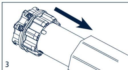
3. Introducir completamente el motor en el tubo de enrollamiento.
