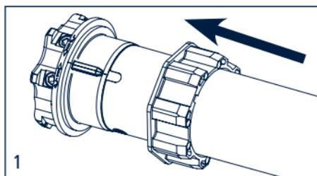
1. Introducir el adaptador en la abrazadera fin de carrera haciendo coincidir la estria con la muesca de referencia y empujar hasta el tope.
