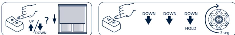
Con el pulsador de subida del inversor pulsador, subir el toldo hasta la posición deseada (en los toldos tipo 'cofre' mantendremos pulsado hasta que el motor pare solo).
