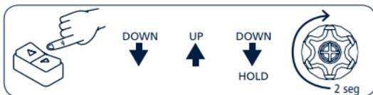
Apretar los pulsadores indicados en secuencia rápida y, en el paso señalado con "HOLD", mantener apretado el pulsador para comprobar que se produce el movimiento de confirmación del motor.
