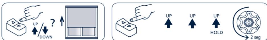
Con el pulsador de bajada del inversor pulsador, bajar el toldo hasta la posición deseada. Para memorizar la posición del fin de carrera inferior, realizar la secuencia de mandos indicada (DOWN-DOWN-DOWN).
