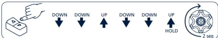
La cancelación de uno o ambos fines de carrera quedará constatada por el hecho de que el motor se moverá brevemente realizando una pausa antes de reanudar el movimiento hasta que ambas posiciones no se memoricen de nuevo.
