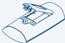
Skipper LCD funciona con dos pilas alcalinas de 1.5 V tipo LR03 (AAA). Para la sustitución de la misma utilizar solamente pilas análogas a las indicadas. Las pilas agotadas deben ser depositadas haciendo uso de los contenedores adecuados y en conformidad con las leyes nacionales.
